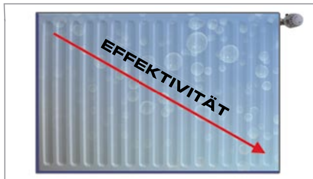
Luft in eine Heizungsanlage verringert die Effektivität
